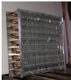
Figura 6.34.- Intercambiador de tubo con aletas herringbone estudiado.
