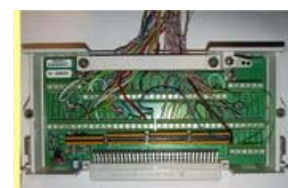
Figura 1.40.- Acondicionamiento de la señal eléctrica de los transductores.
