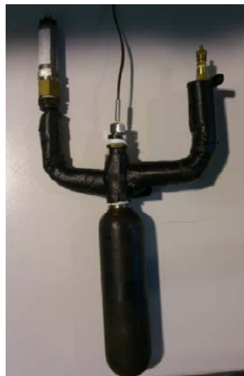
Figura 5.11- Dispositivo para comparar la absorción del refrigerante en los lubricantes
